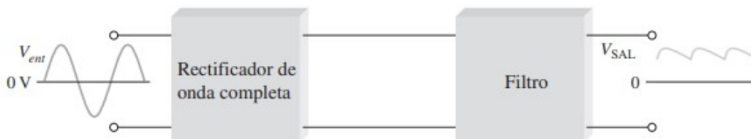
(b) Rectificador con filtro (el rizo de salida está exagerado)
